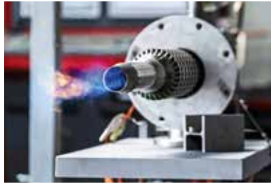
Jens te Kaat stellt im Rahmen des Deutschen Zukunftspreises 2023 einen neu entwickelten Industriebrenner mit integriertem Wärmetauscher vor. Dieser spart nicht nur 15 Prozent Energie und reduziert die Emission von Stickoxiden, sondern kann zudem mit unterschiedlichen Energierohstoffen, etwa Erdgas oder Wasserstoff, betrieben werden.
