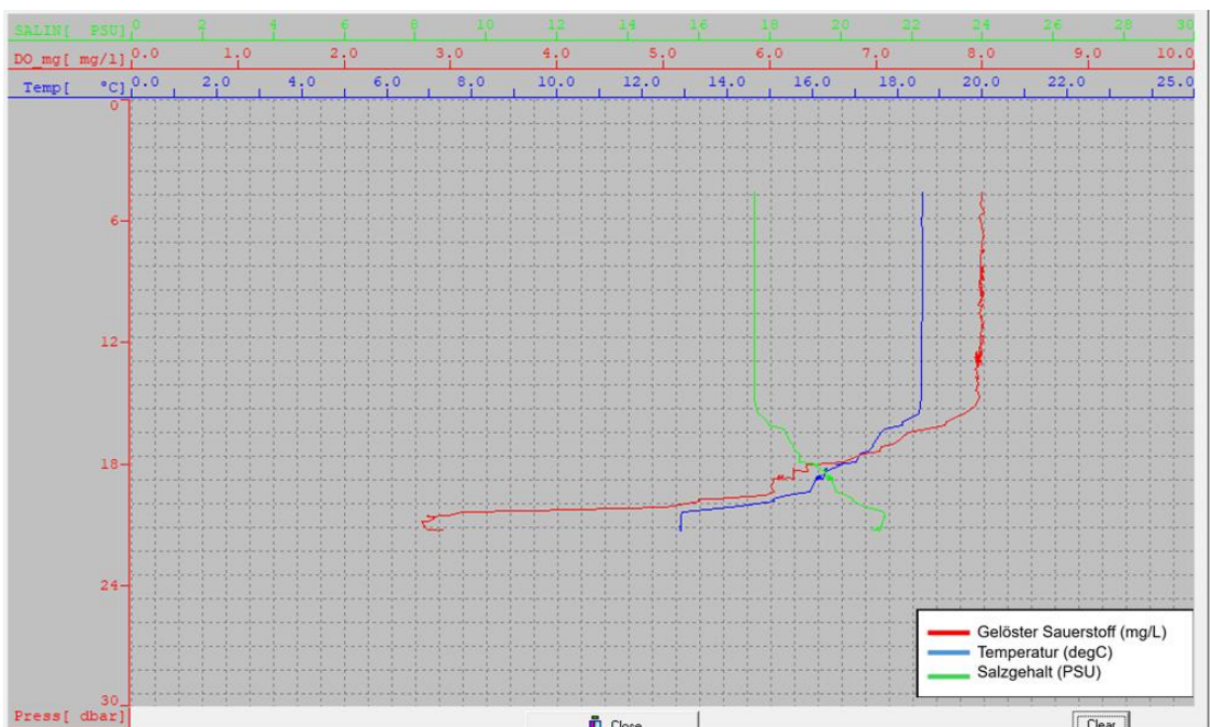
Abb. 2: Kieler Förde 002. Vertikale Profile von Temperatur, Salzgehalt und gelöstem Sauerstoff mit Darstellung der Halokline und des starken Sauerstoffabnahme ab ca. 9 m Wassertiefe. (Bei der Ableitung der Messtiefe wurde der an der Wasseroberfläche gemessene Wasserdruck von ca. 4 dbar (entspricht etwa 4 m Wassertiefe) berücksichtigt).
